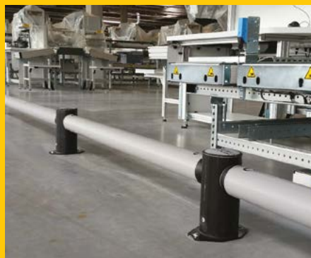
mFlex Single Traffic Barrier vymezuje trasu pohybu manipulační techniky a přístupu k výrobní lince.
