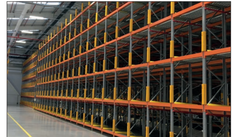
RackGuards lze také nainstalovat nad úrovní nárazové zóny, aby se zabránilo poškození stojin při nakládce ve výškách.
