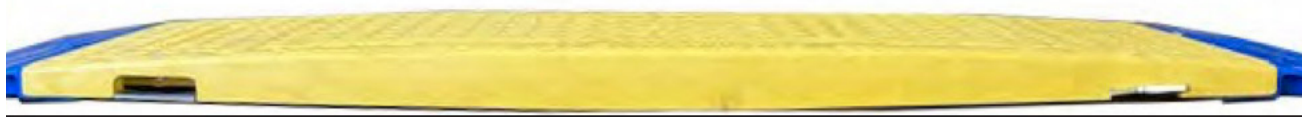
Spodní část žluté části výrobku je viditelně ohnutá. Část musí být plochá.
