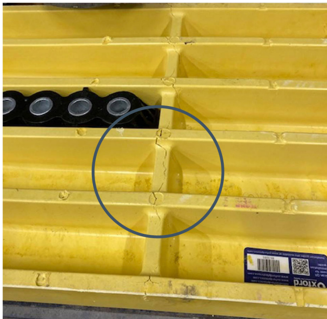
Prasklina podél žebrování
